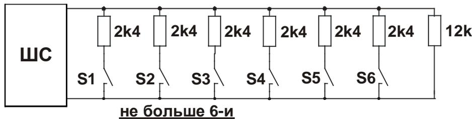
Рис. Схема 6. Параллельное подключение нескольких НР извещателей.
