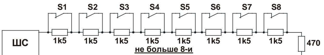
Рис. Схема 5. Последовательное подключение нескольких НЗ извещателей.
