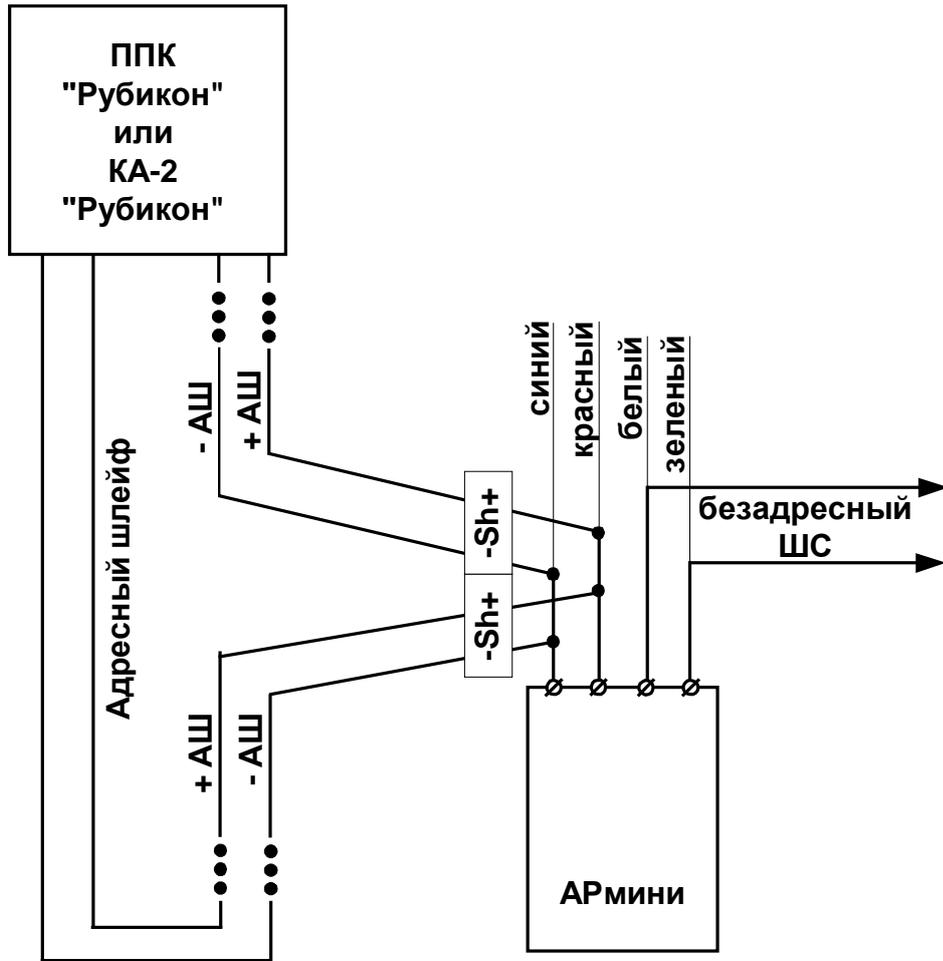
Рис. 2 Подключение АРмини с одним ШС
