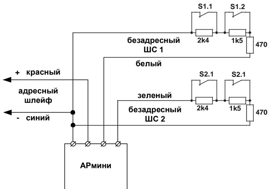
Рис. 5 Пример подключения 4-х извещателей с НЗ контактами.
