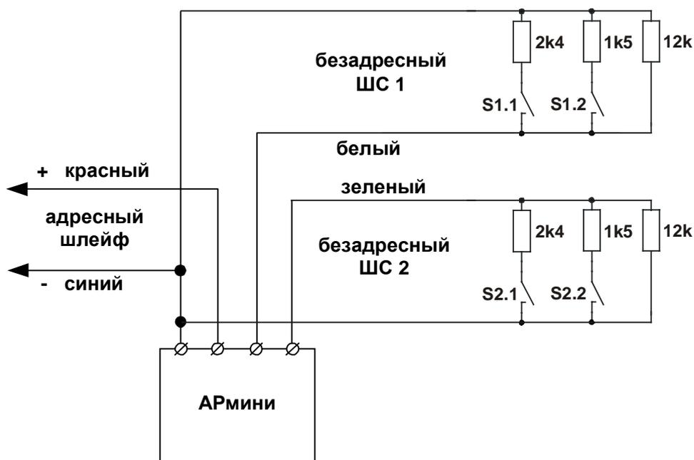
Рис. 6 Пример подключения 4-х извещателей с НР контактами.
