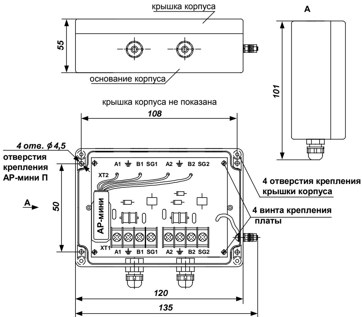
Рис. 11 Конструкция АРмини-П
