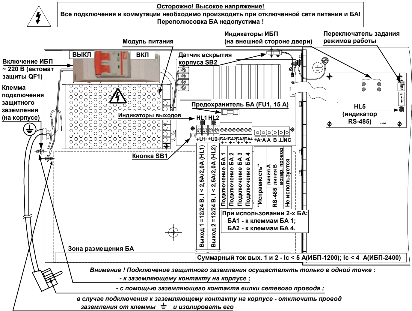
Рис. 2 Внешний вид ИБП-1200/2400 исп. 1 с открытой дверью
